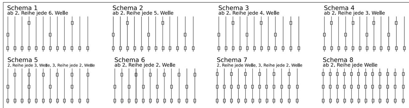
Die Montage des Schnee-Eisfangs erfolgt an der Traufe (1. Reihe) auf **jedem** Wellenberg und in der Fläche nach den oben stehenden Schemen.
